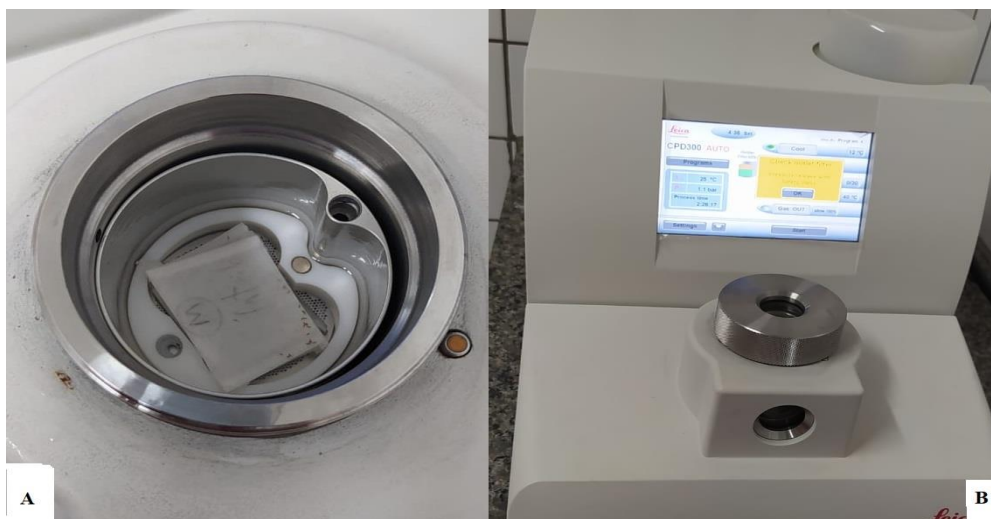
Figura 2: Secagem das lamelas. A) Acondicionamentos das lamelas em envelopes; B) Secagem em ponto crítico de CO 2 .
