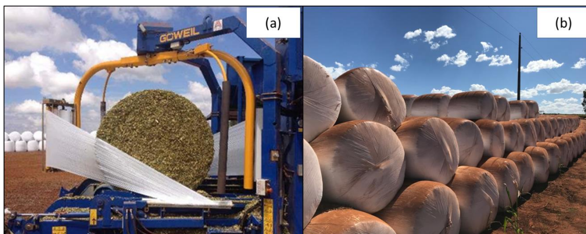
Figura 9. Silo bola (a) Goweil compactando e vedando a silagem (b) Silos vedados.
