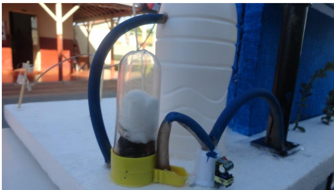
Figura 04: maquete construída pelos alunos sistema coletor de água das chuvas com filtração
